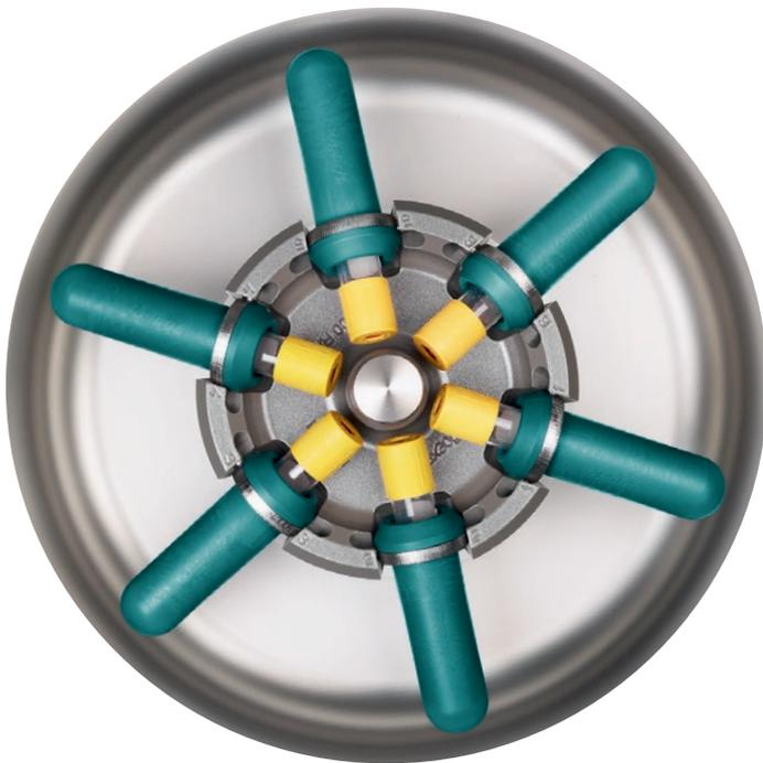
**Vista del espacio de centrifugación** muestra el rotor 1146 con recipientes de extracción de sangre
